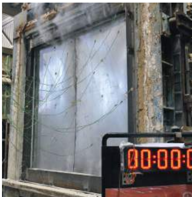
Prova di resistenza al fuoco della porta. Fotografia durante la prova
